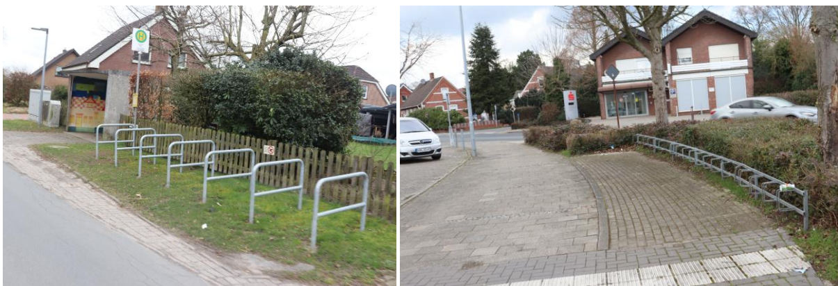
Abbildung 46: Ersetzen der Radparker "Typ Felgenklemmer" durch Anlehnbügel (eigene Fotos (VAR+, 2023))
