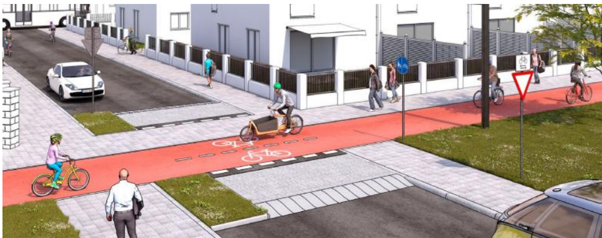
Abbildung 36: Konzeptdarstellung einer exemplarischen Maßnahme mit bevorzugter Straßenüberführung für den Radverkehr (vgl. BMDV, 2022, S. 7)
