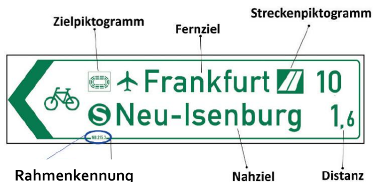
Abbildung 43: Erläuterung der Schilder-inhalte am Bsp. eines Zielwegweisers (Typ Pfeilwegweiser) (vgl. HMWEVL, 2018)
